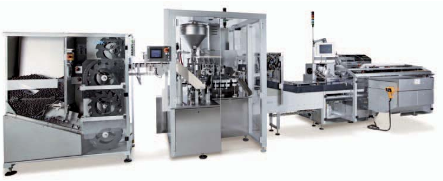
チューブ供給機TZS、チューブ充填機FP 18-1、カートナー SC 5
