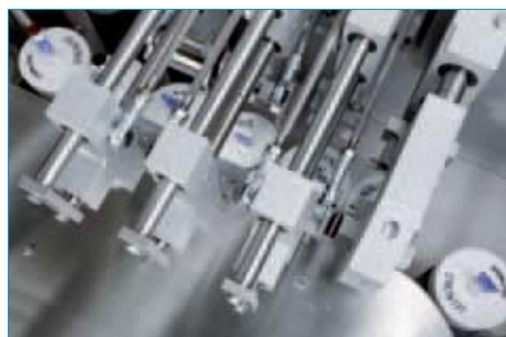
シングル、ダブル、サドル折りに対応したメタルチューブ用モジュール式折り・プレスステーション
